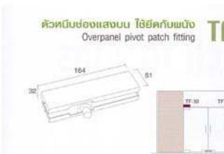
TF-40 ตัวหนีบช่องแสงบนและข้าง Overpanel to sidepanel pivot patch fitting
